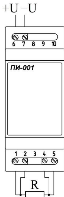
Рисунок 16в – преобразователь в корпусе Д, выходной сигнал 4-20 мА - HART
